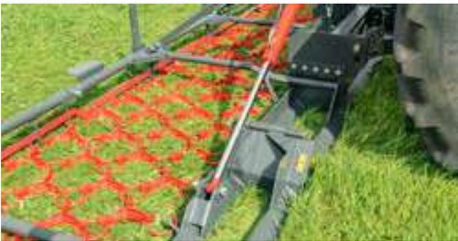
Durch den hochgezogenen Tragrahmen wird eine große Bewegungsfreiheit des Eggenetzes gewährleistet. Die vierreihig angeordneten S-Gußelemente garantieren eine hohe Arbeitsleistung. Die S-Gußelemente können von beiden Seiten verwendet werden: Scharfes Eggen und Belüften mit der Zinkenseite, einfaches Schleppen zum Einebnen von Maulwurfshäufen mit der Glattseite.
