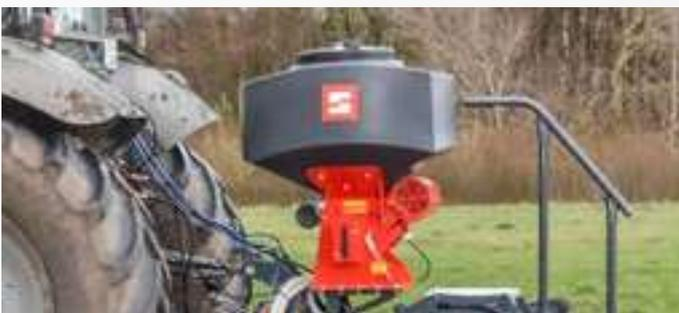
Optional ist das Gerät mit einem SAPHIR DrillStar ausrüstbar. Dieser ermöglicht eine sehr exakte und windunanfällige Nachsaat von Futtergräsern in geschädigten Beständen.
