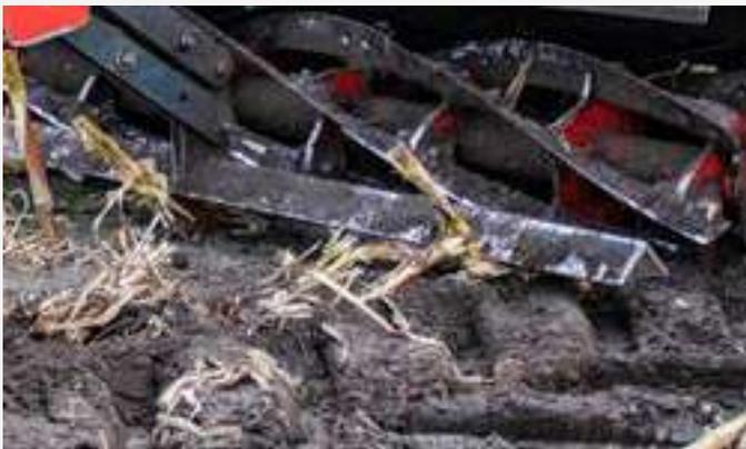
Die optionale Impulsschiene schert Stoppeln ab, spleißt den Wurzelhalsbereich auf und richtet die Stoppel für den engmaschigen Schnitt im Sinusraster aus.
