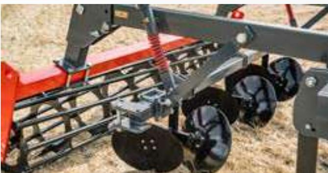
Die Hohl-scheiben sind serienmäßig an einem gefederten Hohl-scheibenbalken (Rohrprofil 80 x 80 mm) angeordnet. Zusätzlich sind die Hohl-scheiben mit einer staubdichten Kugellagerung (geschlossene Ausführung) ausgerüstet. Die Hohl-scheiben sind wahlweise glatt oder gezackt und können sowohl einzeln als auch zentral über den gesamten Balken in der Höhe verstellt werden.
