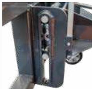
Der selbstsperrende Rollenausgleich gewährleistet einen horizontalen Aushub der Maschine
