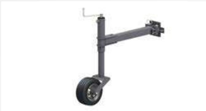
Durch den weit nach hinten versetzten Führungspunkt des Zentralstützrades (16x6.50-8) ist eine noch bessere Höhenführung des Schildes garantiert. Das Zentralrad kann stufenlos über eine Spindelverstellung eingestellt werden. Zum Transport wird es seitlich an den Schildkörper geschwenkt und arretiert.
