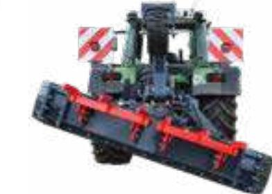
Mit der hydraulischen Neigungsverstellung lassen sich Dachprofile auf Wirtschaftswegen erstellen. Der Verstellbereich beträgt beidseitig max. ca. 22 Grad. Der Verstellbereich kann stufenlos gewählt werden. Der Hydraulikzylinder ist zum Schutz der Schlepperhydraulik mit einem Sperrblock ausgerüstet.
