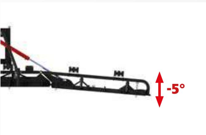
**NEU!** Bei Modellen Perfekt 603 und 803 S4 Hydro ist eine Anpassung im Negativbereich von bis zu  $-5^\circ$  möglich. Eine Begrenzung bzw. Einstellung ist über zwei Justierschrauben an jeder Seite möglich. Dies ermöglicht eine verbesserte Arbeit im kupperten Gelände.
