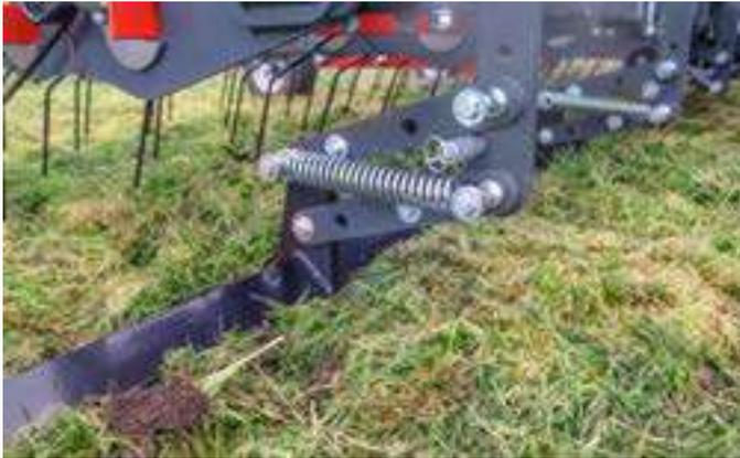
Mit der federbelasteten und parallelgeführten Impulsschiene lassen sich Maulwurfshaufen eiebnen.
