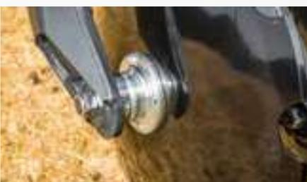
Geringer Verschleiß an den Scheiben durch geringe Kontaktflächen zum Boden und vollständigen Eigenantrieb der Scheibe. Es entsteht keine Reibung zwischen dem Scheibenrücken und dem Boden, wodurch der Verschleiß an der Scheibe minimiert wird. Die gezackten Hohl­scheiben mit einem Durchmesser von Ø 560 mm sind einzeln mit staubdichten und wartungsfreien Qualitätslagern montiert. Der Scheibenabstand beträgt 250 mm.
