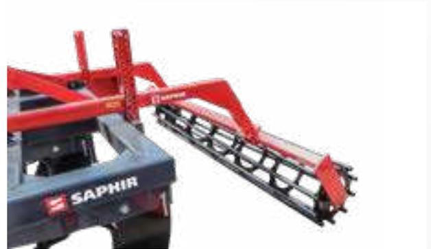
Optionale Rohrpackerwalze (Ø 500 mm) zur Tiefenführung und Rückverfestigung.
