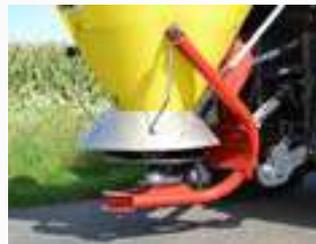
Das optionale Winterset besteht aus einer Schmalstreueinrichtung aus Edelstahl und einem Rührwerk mit Kette.
