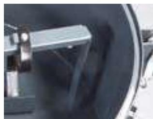
Nachstellbarer Seitenwandabstreifer zur restlosen Entleerung des Mischbehälters.
