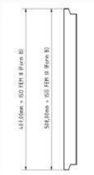
Anbaufertig für die Gabelträgeraufnahme ISO FEM II (407mm) oder ISO FEM III (508mm)
