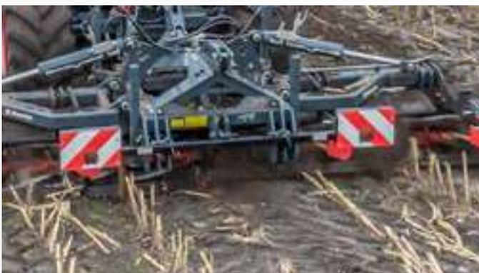
Die Messerwalzen SinusCut 400, 500 & 600 sind serienmäßig mit LED Beleuchtungsanlage inkl. Warntafeln ausgerüstet. Der Beleuchtungsträger ist durch Umstecken sowohl in der Front als auch im Heck nutzbar.
