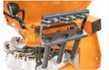
Optional: Der Gerätehalter 1 ermöglicht den sicheren Transport von Schaufeln und Besen.
