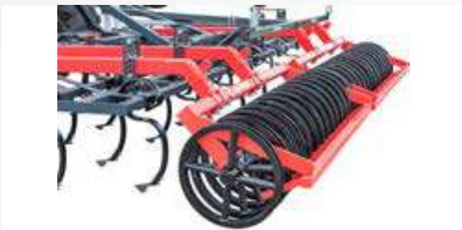
Die U-Profilingwalze bietet mit einem Durchmesser von Ø 540 mm ein breites Einsatzspektrum und kann vielseitig eingesetzt werden. Der U-Profiling nimmt Erde auf und verfestigt somit im „Boden zu Boden“-Verfahren. Dadurch wird eine offenporige Bodenoberfläche hinterlassen.
