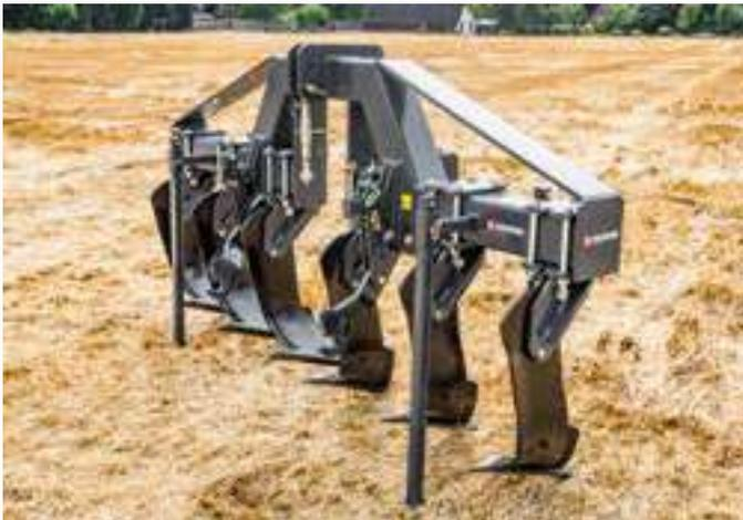
Die serienmäßige Steinsicherung mittels Abscherbolzen garantiert eine besonders lange Lebensdauer von Grindel und Rahmen. Im Heck der Maschine steht eine Dreipunktaufnahme Kat. II für die Kombination mit einem weiteren Anbaugerät zur Stoppel- oder Saattbettbearbeitung (max. 1.600 kg) zur Verfügung.
