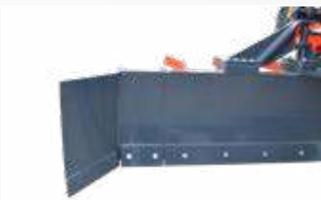
Die Seitenbleche werden am Seitenteil oder an der Schildverbreiterung verschraubt. Sie sind um 45 Grad abgewinkelt. Bei Planier- oder Wegebauarbeiten wird somit bei schrägestelltem Schildkörper das Abrutschen des Materials in den Seitenraum verhindert.
