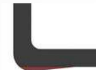
Zinken mit Verschleißschutz im Knickbereich
