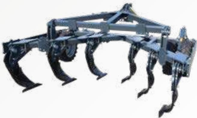
Robuster Vierkanrahmen in V-Form zur optimalen Kraftaufnahme.
