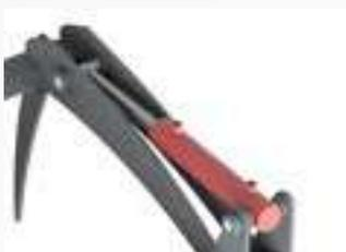
Hydraulische Oberzange mit zwei doppelwirkenden, endlagendämpften Hydraulikzylindern
