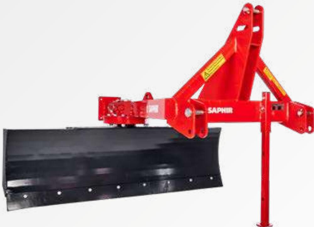
Die SAPHIR Planierschilder CONTOUR sind robuste, mechanisch verstellbare Schilder für leichte Planier- und Wegebauarbeiten mit Traktoren bis 73kW/100PS Leistung. Sie eignen sich außerdem für den Schneeräumeinsatz. Der Schildkörper kann serienmäßig um 360 Grad durchgeschwenkt werden. Somit kann das Schild auch im Frontanbau verwendet werden. Die Verriegelung erfolgt über einen Steckbolzen in Stufen von jeweils 22,5 Grad.
