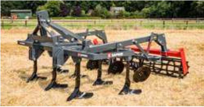
Starke Vierkantprofile machen den Rahmen besonders verwindungssteif. Der weite Balkenabstand und die große Durchgangshöhe (800 mm) sorgen für verstopfungsfreies Arbeiten.
