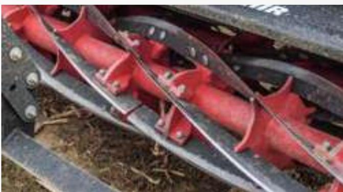
Durch die zwei entgegengerichteten Messerwalzen ergibt sich daraus das einzigartige Sinusraster, wodurch ein engmaschiges Schnitttraster entsteht. Organische Reste werden auf diese Weise effizient zerkleinert.
