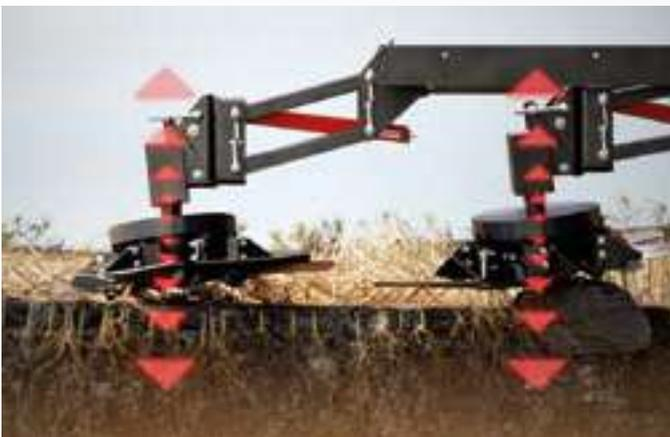
Die gleichmäßig flache Bearbeitung stellt die parallelogrammgeführte Aufhängung der Werkzeuge sicher. Durch die federbelasteten Messerwerkzeuge und das speziell entwickelte Druckentlastungssystem im Rotor wird eine optimale horizontale und vertikale Führung der Arbeitswerkzeuge erreicht. Erst damit wird eine wesentlich verbesserte Boden-anpassung als bei herkömmlichen Konzepten möglich.
