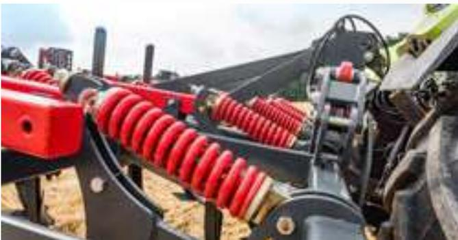
Bei steinigem oder harten Bodenverhältnissen empfiehlt sich eine automatische Steinsicherung (Modell TerraStar S Profi). Die Überlastsicherung erfolgt durch eine sehr stabile Druckfeder mit Schmiernippeln an den Drehpunkten. Die Zinken werden nach Überwinden des Hindernisses immer wieder in Arbeitsstellung zurückgestellt. Die Auslösekraft beträgt 500 kg.
