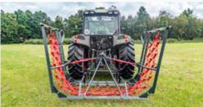
Für den besonders bedienerfreundlichen Wechsel in Transportposition können die Geräte ab 5-mtr. Arbeitsbreite mit einer hydraulischen Klappvorrichtung optional ausrüstbar (bei Perfekt 602 W Hydro serienmäßig). Für die Sicherheit im Straßenverkehr ist für alle Modelle eine optionale Beleuchtungsanlage inkl. Warntafeln erhältlich.
