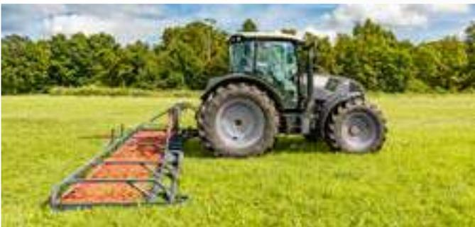
Der besonders robuste Rahmenaufbau besteht aus einem schweren Dreipunktturm und verstärkten Breitband-Klappschanieren. Die Unter- und Oberlenkerbolzen sitzen in stabilen Aufnahmetaschen.
