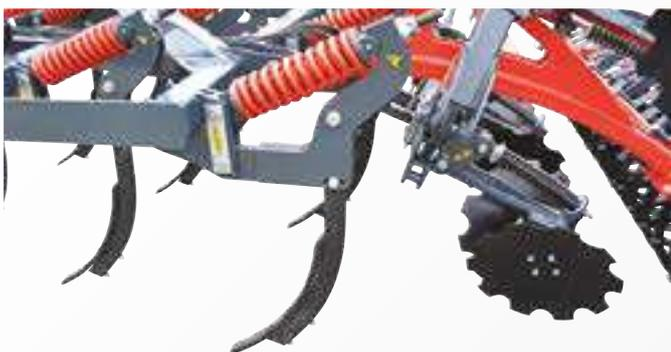
Bei besonders steinigem und harten Verhältnissen empfiehlt sich eine automatische Steinsicherung. Die Auslösekraft der Druckfeder liegt bei über 550 kg, wodurch auch unter schwersten Bedingungen ein effizientes Arbeiten ermöglicht wird. Der Scharwinkel kann den Bodengegebenheiten angepasst werden. Je flacher der Winkel, desto intensiver ist der Mischeffekt.
