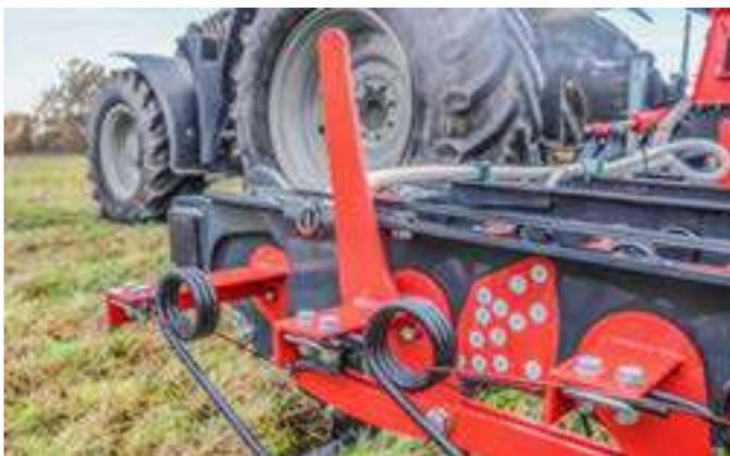
Der Exaktstriegel Perfekt ES verfügt über drehbare Zinkenträger. Die Verstellung der Zinkenaggressivität erfolgt mechanisch per Lochraster.
