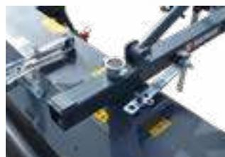
Serienmäßig mechanisch um 30° schwenkbar, optional hydraulisch
