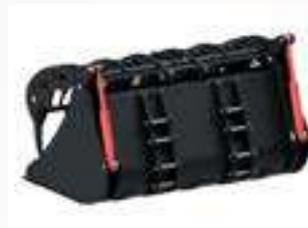
Großdimensionierte Hydraulikzylinder mit Endlagerdämpfung für materialschonendes Schließen der Oberzange
