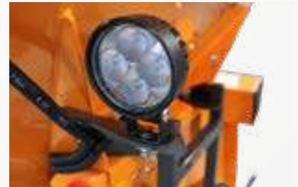
Optional: LED Arbeitsscheinwerfer für eine optimale Sicht auf den Arbeitsbereich und einen somit noch höheren Arbeitskomfort.
