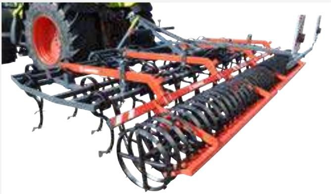
Auf mittleren und schweren Böden sorgt die Dachringwalze im Einsatz zur Stoppelbearbeitung für eine streifenweise Rückverfestigung des Bodens. Dies bietet optimale Voraussetzungen für einen gleichmäßigen Auflauf des Ausfallgetreides, sowie Unkrautsamen und schützt den Boden zusätzlich vor Erosionen. In der Saatbettbereitung wird eine hohe Rückverfestigung für einen bestmöglichen Feldaufgang der darauffolgenden Frucht erreicht. Die Dachringwalze ist für alle Bodenverhältnisse geeignet.
