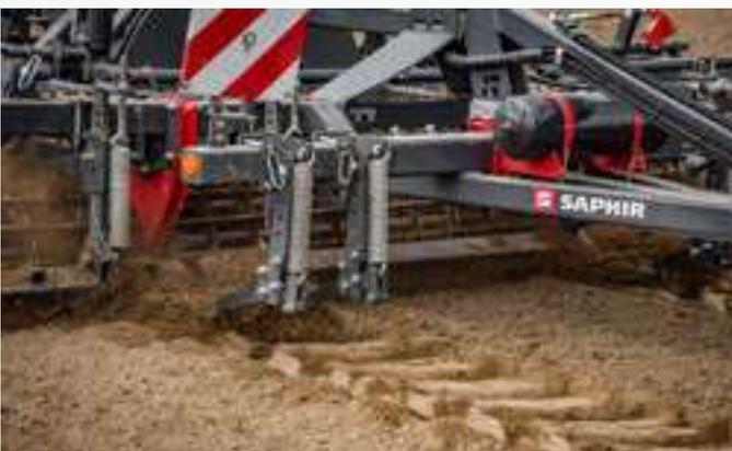
1. Spurlockererzinken (nur für Fahrwerksmaschinen)
