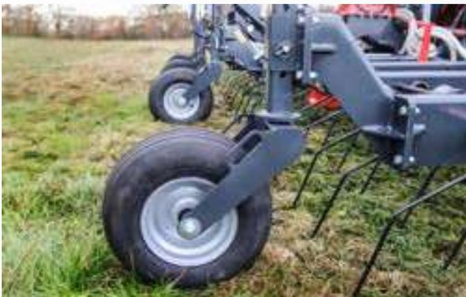
Nachlaufende Stützräder (luftbereift, frei drehend 90°) sorgen für eine optimale Bodenangepassung und einen ruhigen Lauf.
