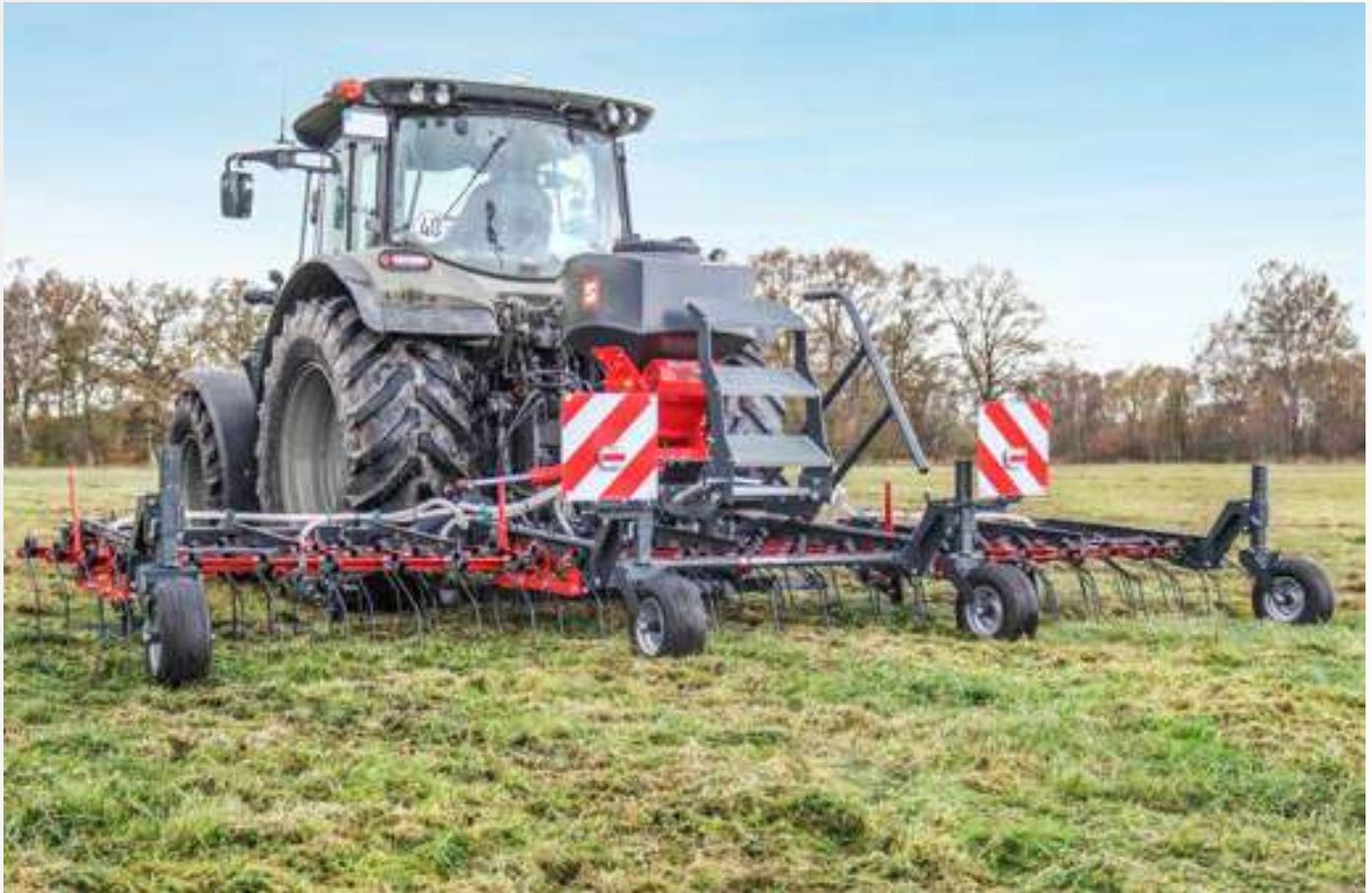
Der Saphir Exaktstriegel Perfekt ES ist speziell für die Grünlandpflege mit kleineren Traktoren und für sehr kuppertes Gelände entwickelt worden. Durch die exakten Einstellmöglichkeiten eignet sich diese Baureihe auch für die Zwischenfruchtaussaat. Abgestorbenes Altgras und gemeine Rispel können effektiv ausgekämmt werden. Die Einebnung von Maulwurfshäufen erfolgt durch die federbelastete Impulsschiene. Frei drehbare Stützräder sorgen für eine optimale Boden Anpassung und Tiefenführung.
