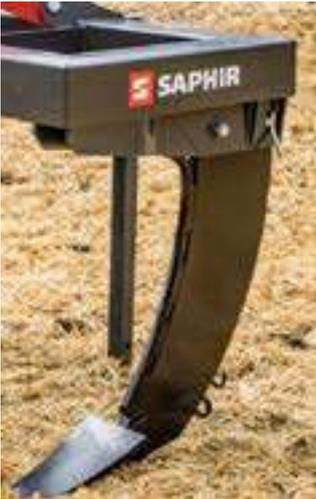
Die serienmäßige Steinsicherung mittels Abscherbolzen garantiert eine besonders lange Lebensdauer von Grindel und Rahmen.
