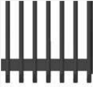
Rundstähle mit einem Durchmesser von 30 mm und einer lichten Stabweite von 60 mm
