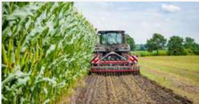
Um die Maschine komfortabel von Transport- auf Arbeitsstellung umzustellen, wird als Option eine hydr. Randscheibenklappung angeboten. Die hydr. Klappung dient weiterhin zum flexiblen Einziehen der Randscheiben, um die Randbearbeitung an Feldrändern und Gehölz zu erleichtern. Die Zylinder sind in dem Trägerprofil der Randscheiben intelligent verbaut, um eine Beschädigung durch Steinschlag zu verhindern.
