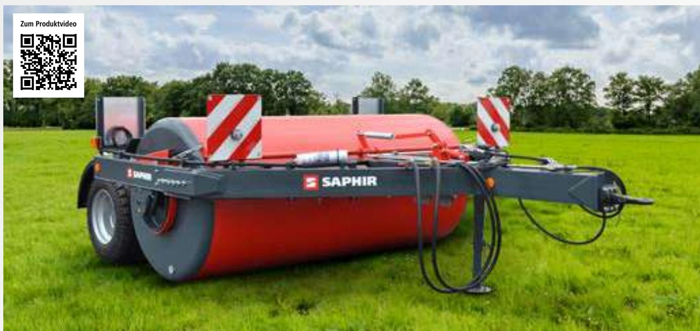
Die SAPHIR Wiesenwalze Robust FG ist mit einem zusätzlichen Fahrwerk ausgestattet. Die nah am Walzenkörper laufenden Räder vereinfachen den Straßentransport und ermöglichen einen komfortablen Feldwechsel.
