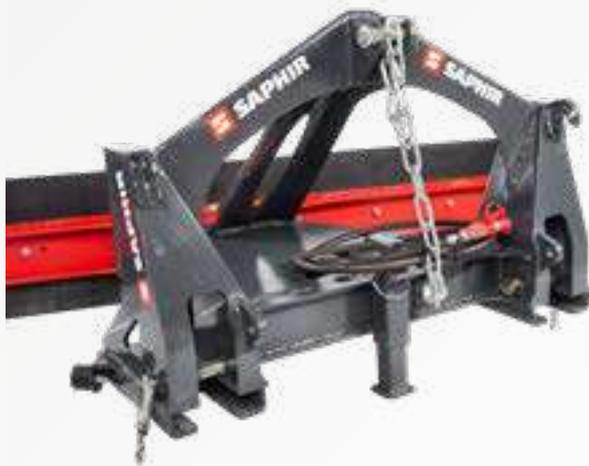
Aufnahmemöglichkeit für Euro / Gabelträger / Kat. II kombiniert, optional auch mit Aufnahmen für Hof- und Radlader bis 2,5 t Hubkraft bzw. Rad- und Teleskoplader ab 2,5 t Hubkraft erhältlich
