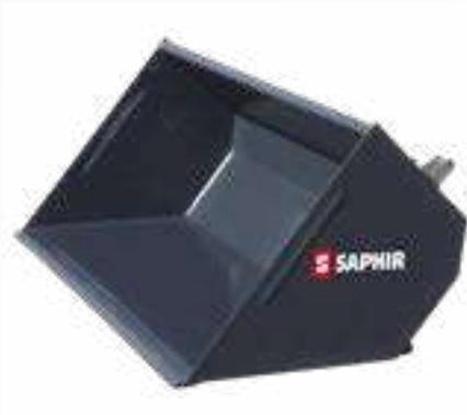
Bei der SAPHIR Kotgangschaufel handelt es sich um eine extra breite Schaufel (1.850 mm), welche dank der außenliegenden Aufnahme ohne die sonst üblichen Taschen auskommt. So kann sich dort kein Material sammeln und anstauen, außerdem eignet sich die Kotgangschaufel optimal zum ausmisten.
