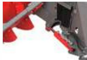
Hydraulische Schwenkung um 20° zu beiden Seiten ermöglicht eine exakte, seitliche Verteilung der Silage
