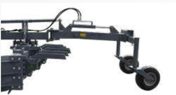
Mit der hydr. Höhenführung kann die Tiefe stufenlos eingestellt werden. Die Parallelführung sorgt für eine exakte Führung. Der integrierte Niveauegleich ermöglicht das Erstellen von Dachprofilen.
