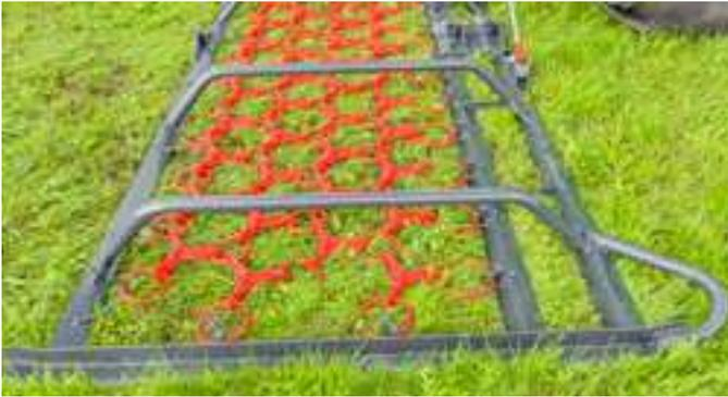
Die in vier Reihen angeordneten W-Gußelemente garantieren eine optimale Arbeitsleistung. Die Gußelemente sind beidseitig verwendbar: Zinkenseite für scharfes Eggen und Belüften der Grasnarbe, Glattseite zum Verteilen von Kuhfladen und Einebnen von Maulwurfshaufen. Die Grünlandeggen Perfekt W4 verfügen über zwei hintereinander angeordnete Winkeleisen in der Front der Maschine, diese sorgen für einen Zwangseinebnungseffekt von Maulwurfshügeln und Unebenheiten.
