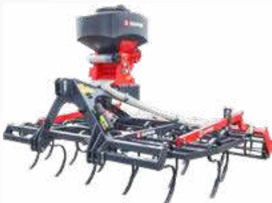
Das Modell AllStar 301 Profi hat einen durchgängigen Rahmen. Die zulässige Transportbreite von 3,0 m wird eingehalten. Das Gerät kann bereits mit Traktoren ab 44 kW / 60 PS betrieben werden. Durch die umfangreichen Sonderausrüstungen lässt sich das Gerät optimal an verschiedene Einsatzbereiche und Bodenbedingungen anpassen.
