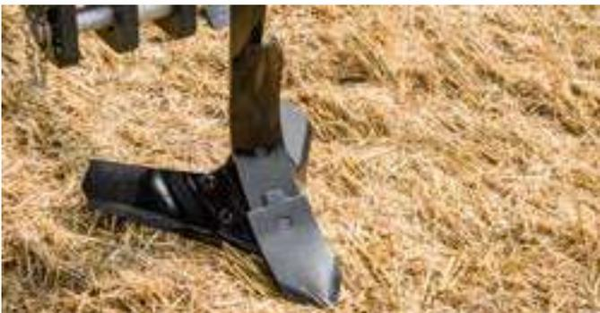
Alle Modelle sind serienmäßig mit Flügelscharen ausgerüstet. Die gekrümmten Flügelschare gewährleisten eine optimale Durchmischung des Bodens auch bei flacher Stoppelbearbeitung.
