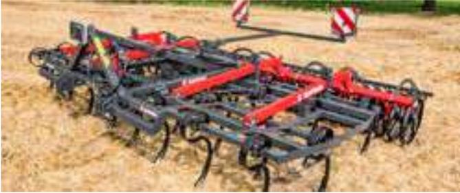
Der Rahmen der SAPHIR Großfederzinkeneggen AllStar 401, 501 und 601 ist zweiteilig aufgebaut. Die Klappung erfolgt über einen großdimensionierten Hydraulikzylinder (mit integriertem Sperrblock) in der Mitte. Das Gerät kann eingeklappt problemlos abgestellt werden. Der 4-balkige Rahmen aus Rohrprofil 60 x 60 mm ist mehrfach verstrebt und garantiert damit höchste Stabilität.
