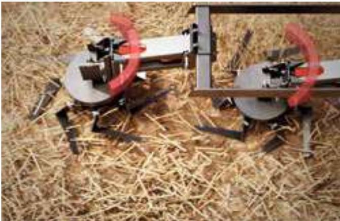
Die Werkzeuge sind an passiv angetriebenen Rotoren verbaut, die wiederum auf zwei Reihen montiert sind. Dabei ist die Drehrichtung der vorderen Rotoren entgegengesetzt zur Drehrichtung der hinten angebrachten Rotoren. Durch diese Anordnung und den spiegel-symmetrischen Aufbau der Rotoren ergibt sich ein ganzflächiges Arbeitsbild.
