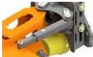
Mechanische Schwenkeinrichtung in zwei Stufen um 10° und 20° beidseitig.
